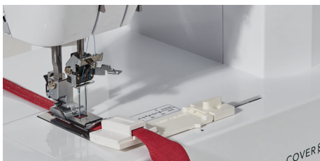
Zakladač pro šití poutek, hotová šířka 11mm
